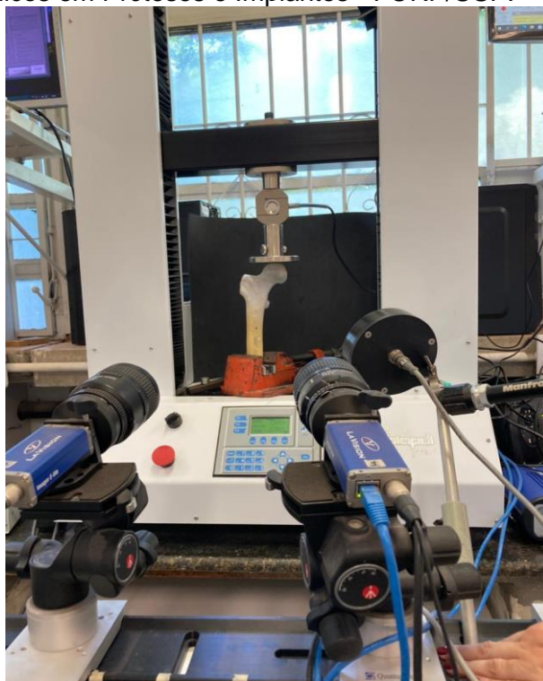
FIGURA 4: Máquina universal de ensaios e sistema de correlação de imagem digital Materiais usados para desenvolvimento do projeto, do Laboratório de Estudos Biomecânicos em Próteses e Implantes - FORP/USP.
