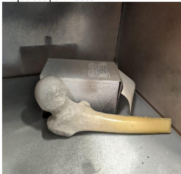
FIGURA 6: Osso sintético do fêmur após a aplicação de spray de tinta branca e de tinta preta para a realização dos pontilhados.
