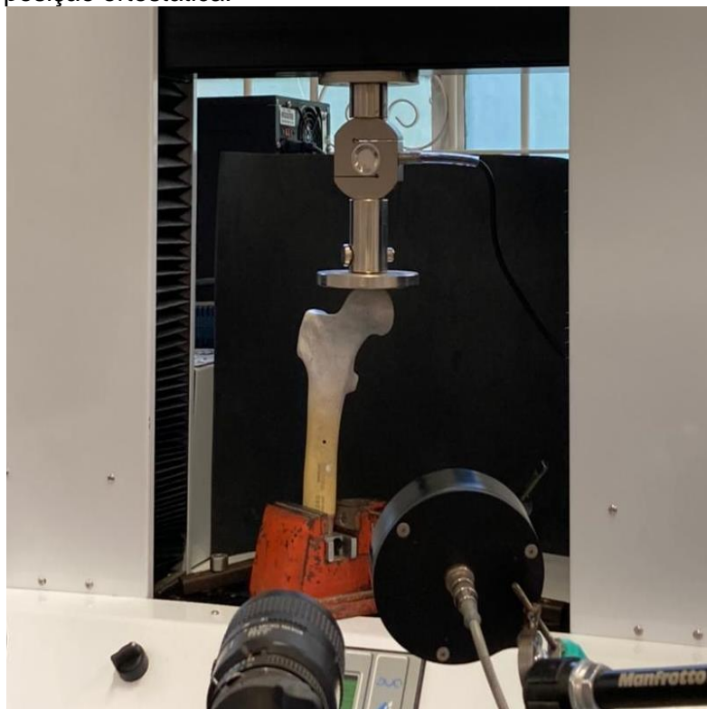
FIGURA 8: Máquina universal de ensaios mecânicos Biopdi, realizando o ensaio com o osso em posição ortostática.
