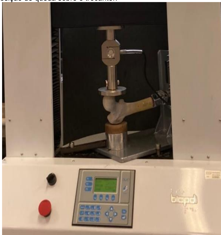
FIGURA 10: Máquina universal de ensaios mecânicos Biopdi, realizando o ensaio com o osso em posição de queda sobre o trocanter.
